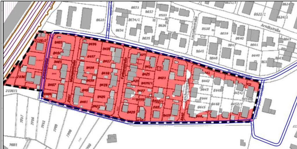
Pegelwerte über 50 dB(A) nachts, Rechenhöhe 8 m über Gelände (Dachgeschoss)
