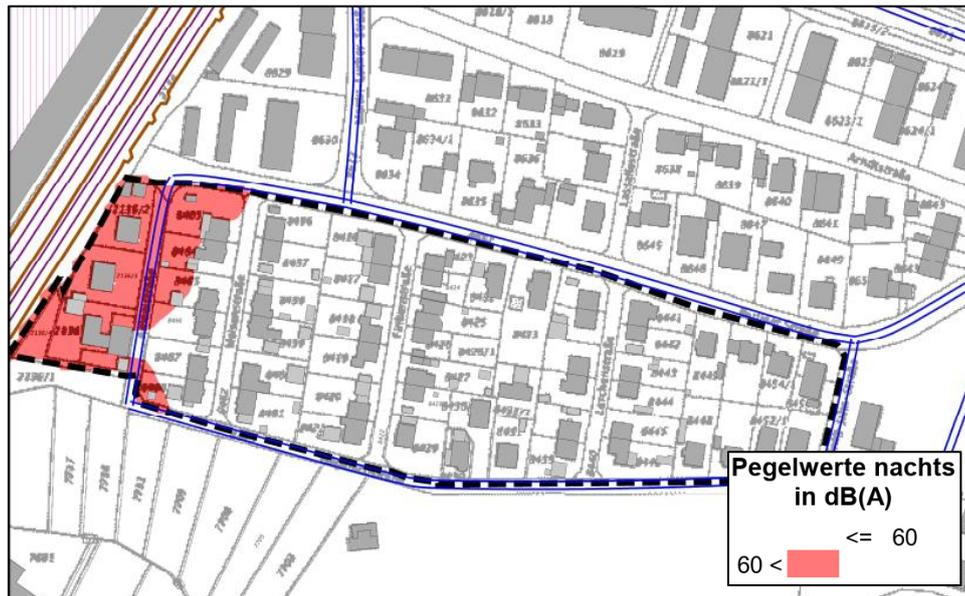
Abb. 1: Pegelwerte über 60 dB(A) nachts, Rechenhöhe 8 m über Gelände
